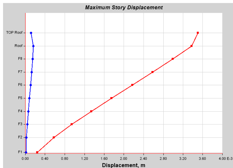
รูปที่ 6.2 Maximum story Displacement in X & Y Direct due to Wind Y
